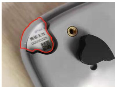
充电桩本体安装螺丝孔处贴有保修防拆标签，非授权拆开将失去保修资格。授权人员如需进行开箱操作，需要在操作完成后，重新贴我司授权的保修防拆贴纸，并在维修单记录贴纸追踪号码。
