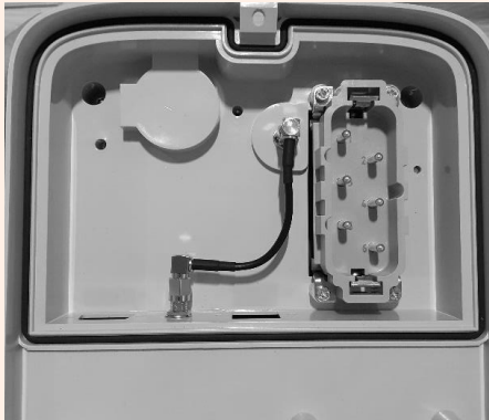
Conectarea antenei interne
