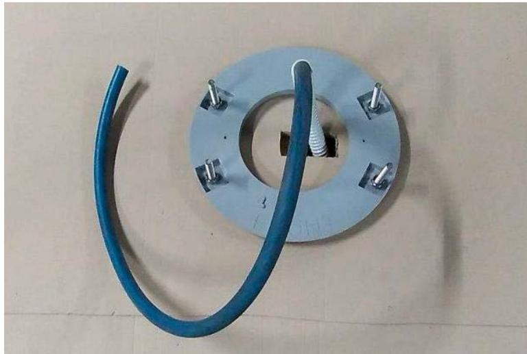
Eliminar a Tampa central do Revestimento e inseri-la nas Garras no sentido indicado, inserindo o Cabo de alimentação no orifício central (Exemplo com 5 polos - Consultar também o Anexo B).
