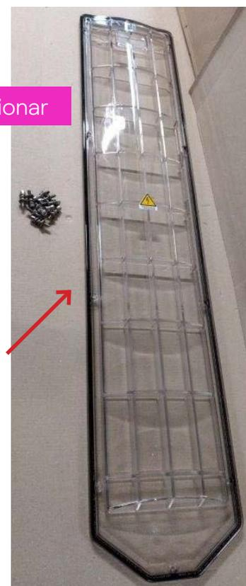
Desaparafusar a proteção em "lexan" da Caixa de Terminais, voltando a colocá-la com os 2 parafusos em um local seguro.
